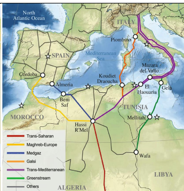
Карта-схема 2. Підводні трубопроводи в Середземному морі, по яких газ подається з Алжирі до Іспанії та Італії.
