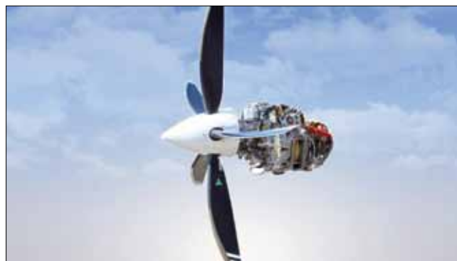
«Серцем» Ваурактар Акінци є два турбогвинтові двигуни потужністю 450 к.с. українського ДП «Івченко-Прогрес»
