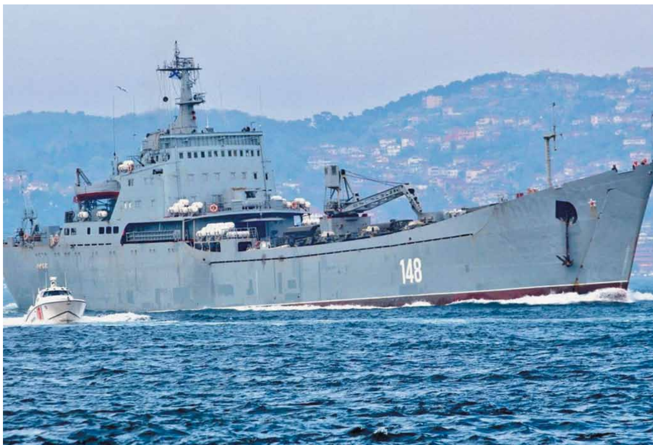
Рис. 1. Великий десантний корабель «Орск», Проєкт 1171 «Танір». Кораблі цього проєкту є основою російського десантного флоту та призначені для висадки морського десанту на необладнане узбережжя та перекидання морем військ та вантажів.
